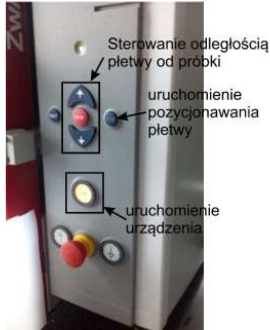
Rys. 12 Maszyna wytrzymałościowa ZwickRoell Z2,5 - sterowanie
