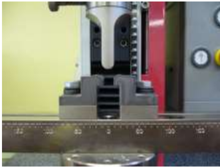
Rys. 17 Urządzenie oraz kształt, ułożenie i wymiary próbki do badania K_{Ic}
