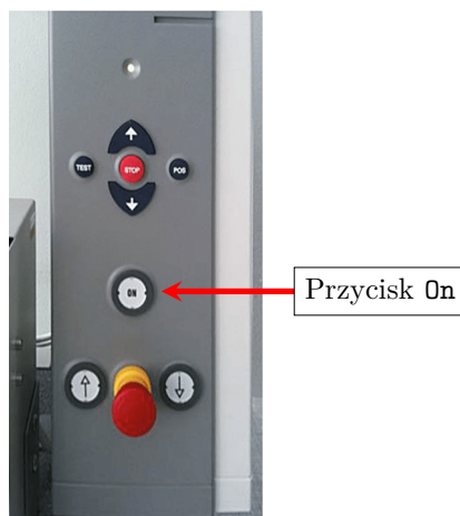
Rysunek 4. Panel sterujący maszyny wytrzymałościowej
