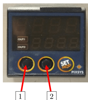
Rysunek 2. Panel sterujący oporowego pieca rurowego: 1 – podnoszenie temperatury, 2 – obniżanie temperatury
