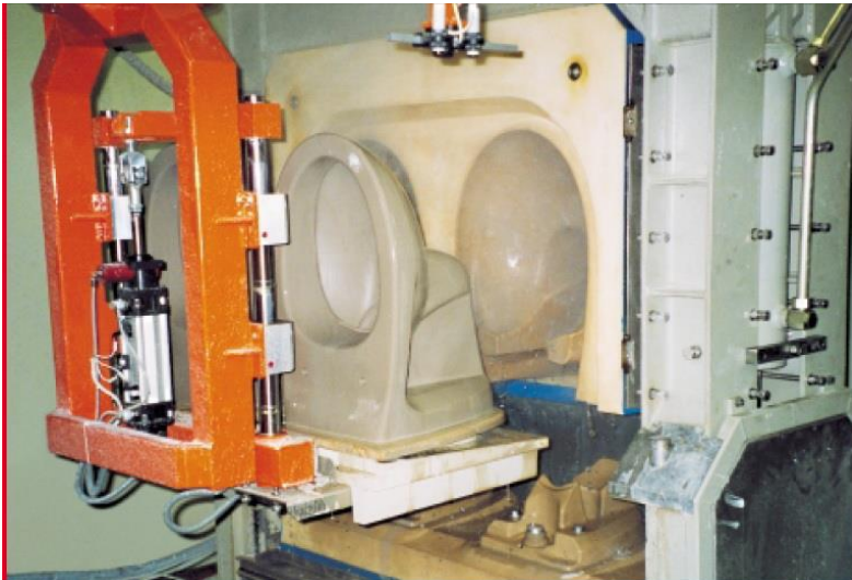
Rys. 15. Stanowisko do odlewania wysokociśnieniowego formach akrylowych (Sacmi Forni) ceramiki sanitarnej.
