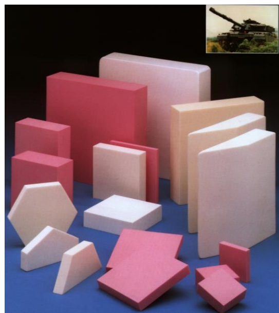
Rys. 6. Płytki ochronne stosowane w pancierzach ochronnych m. in. dla czołgów.
