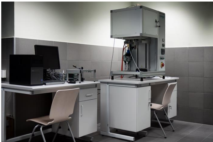
Rys. 12 Aparatura pomiarowa metodą rezonansu
