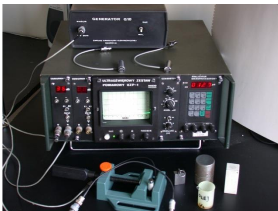
Rys. 7 Aparatura do pomiarów ultradźwiękowych
