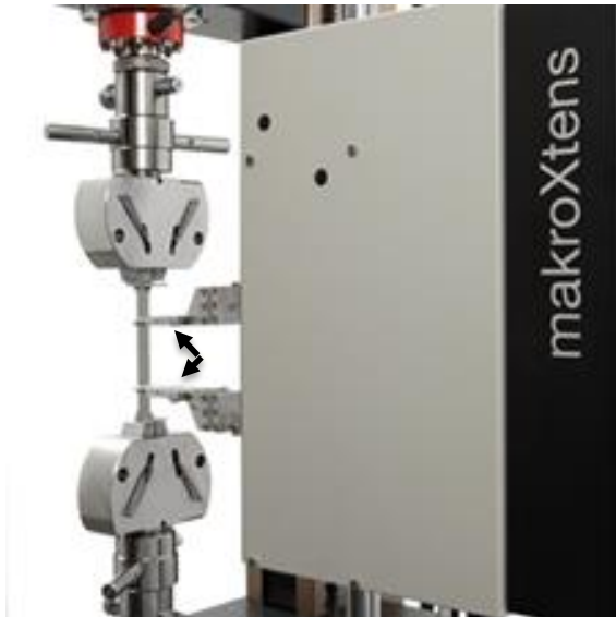
Rys. 4 Pomiar wydłużenia przy próbie rozciągania ZwickRoell - http://www.zwick.pl/pl/produkty.html
