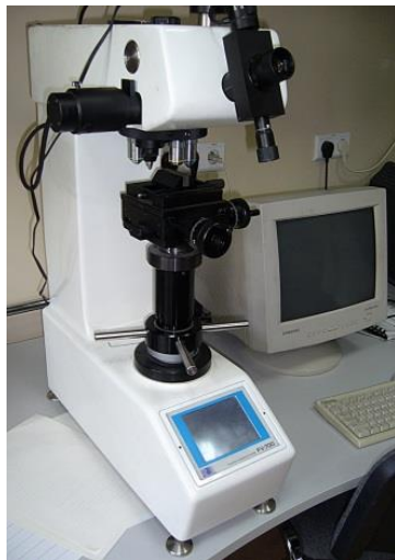
Rys. 14 Geometria Twardościomierz firmy Futuretech
