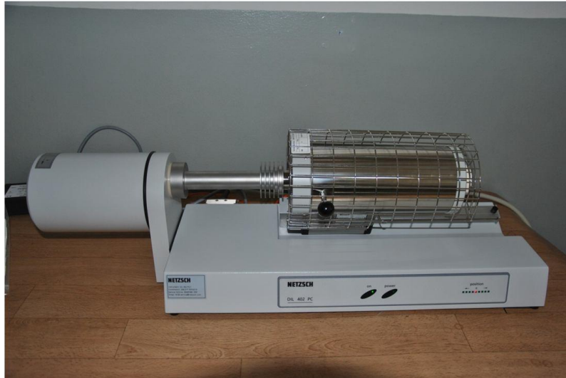
Rys. 6 Dylatometr DIL 402 PC – wykorzystywany podczas ćwiczenia
