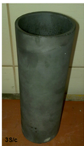
Cylindryczne wyroby z SiC i \text{Al}_2\text{O}_3 formowane metodą odlewania odśrodkowego
