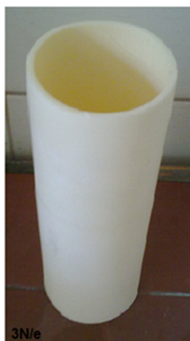
Cylindryczne wyroby z SiC i \text{Al}_2\text{O}_3 formowane metodą odlewania odśrodkowego
