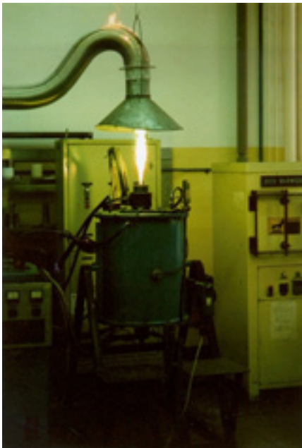
Widok stanowiska badawczego do spalania w fazie stałej
