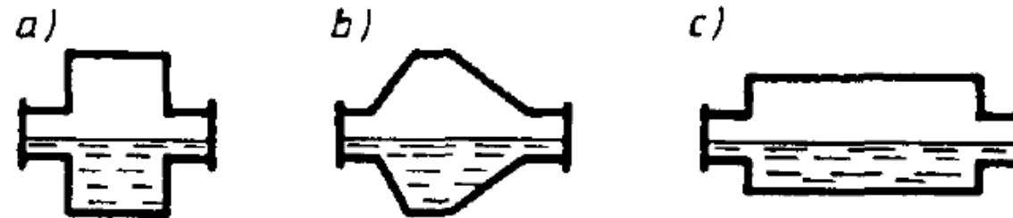
Rys. 8.11. Typy młynów kulowych: a) bębnowy, b) stożkowy, c) rurowy
